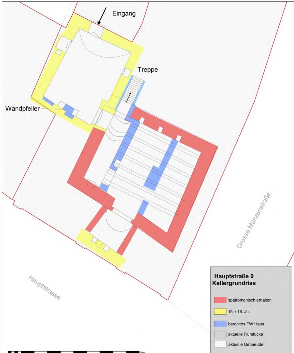
Abb. 18 Hauptstraße 9, Kellergrundriss mit Baualterskartierung, Zustand der Barockzeit (Plan: J. Müller).
